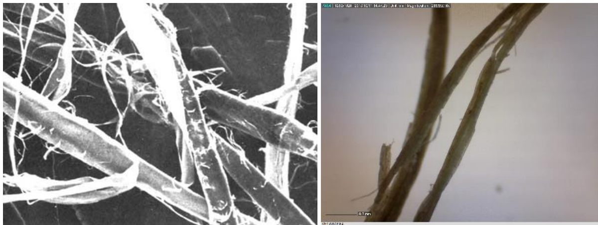
Figuur 3: Microscopische opname papiervezel (links) en een agrovezel (rechts)
